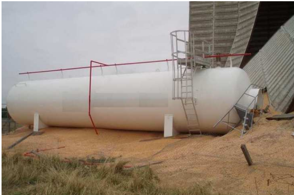
Exemple de rupture d'une capacité de stockage ayant entraîné une rupture de canalisation sur une citerne de gaz.
