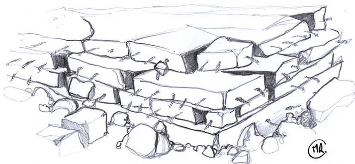
L'effondrement en oblique © Matthieu Robert – SDIS 85
