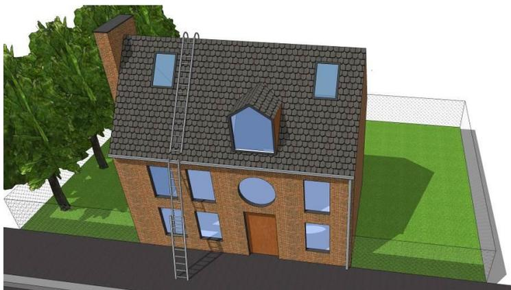
Échelle à crochets sur le faitage d'une toiture (ou d'un plan incliné) afin de faciliter un sauvetage ou la progression des sapeurs-pompiers.
