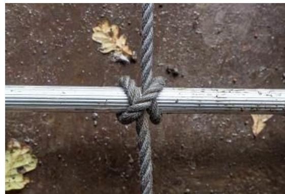
*Le blocage des plans au moyen d'une sangle ou du trait est obligatoire afin d'éviter le désengagement des parachutes et le déploiement intempestif de l'échelle lors de sa mise en place.*
