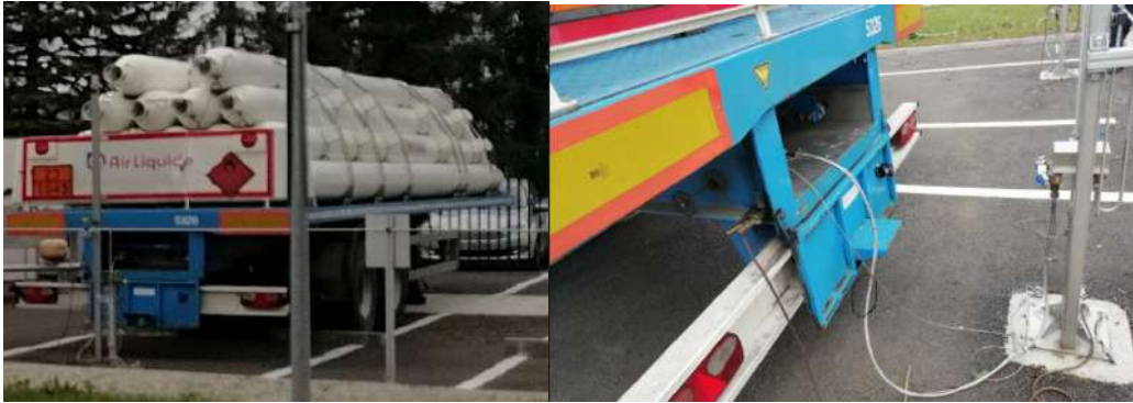
Semi-remorque transportant des « cigares » d'hydrogène © Air-liquide
