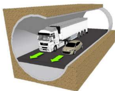
Tunnel monotube à circulation unidirectionnelle
