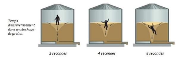
L'agglomération des grains: Lors d'un stockage prolongé, les grains se détériorent en raison d'une augmentation de la température ou de l'humidité. La conséquence sera l'apparition de colonnes sur les parois du silos ou un pont de grains (effet de voûte), la rupture de ces deux agglomérations est un risque à prendre en compte tant pour les opérateurs travaillant sur ce type d'installation mais aussi par les sauveteurs durant la durée de l'intervention.
