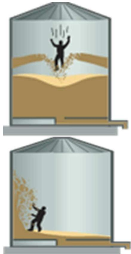
**Le glissement de grain :** La présence d'une pile de grain plus haute que la taille d'une personne est un facteur de risque. L'empilement du grain avec un angle supérieur à son angle de repos (angle de talutage) augmente ce risque.
