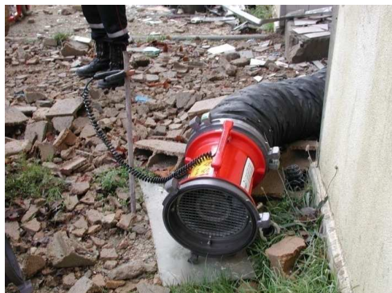
Illustration n°2 : Utilisation d'un hydro ventilateur
