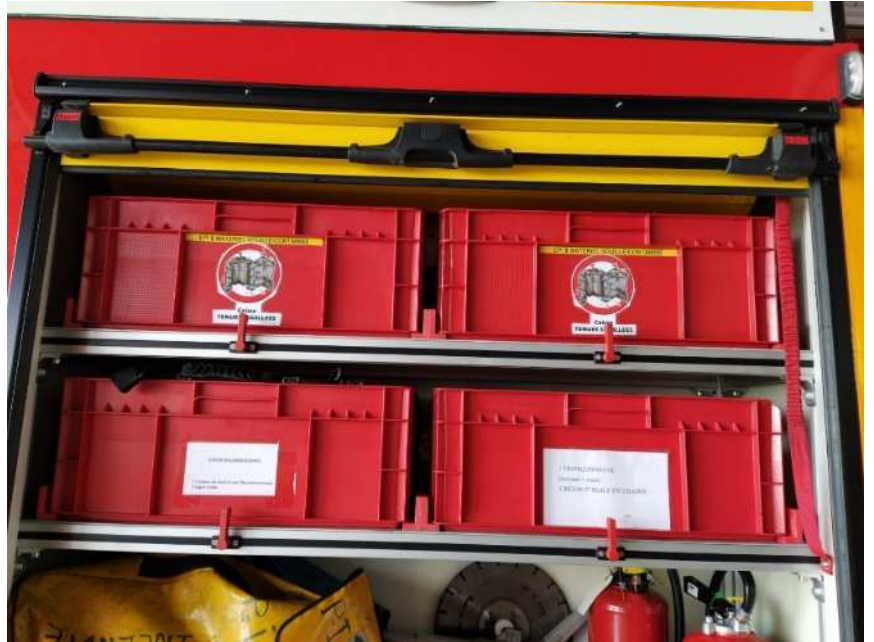
Les EPI et matériels qui restent souillés doivent être mis à l’écart des matériels propres dans les véhicules (sacs spécifiques, bacs étanches ou espaces dédiés). © Maxime Fonteneau – SDIS 85
